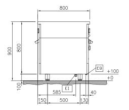
Electrical inlet (power) Equipotential screw
